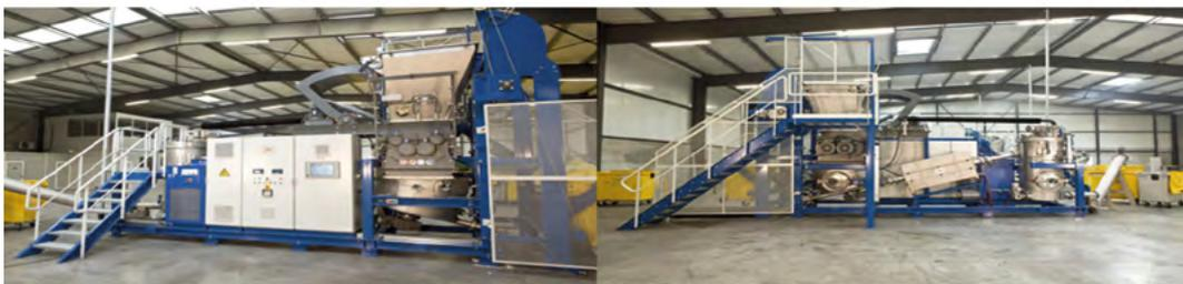
**Figura 3 Imagen de sistema de tratamiento de vapor continuo**
