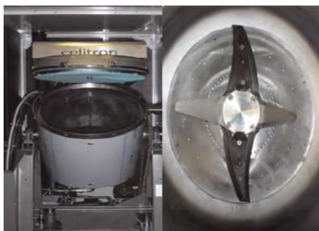
**Figura 2. Autoclave híbrida**
