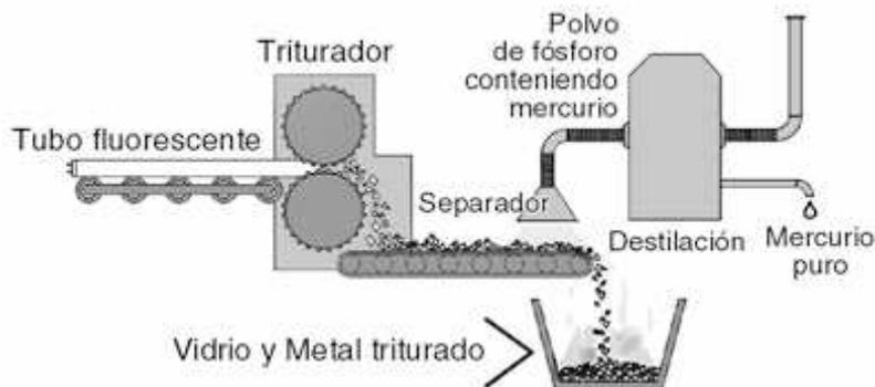
**Figura 4-22** Esquema del un proceso de reciclaje de de tubos fluorescentes
