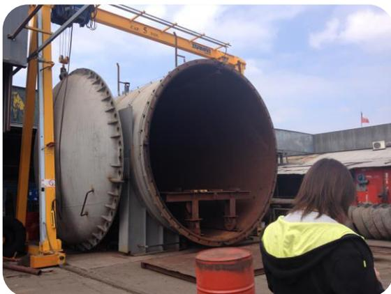
Presencia de autoclaves que permiten el control en tiempo real. Incluye seguimiento de cada neumático desde que ingresa al autoclave hasta que sale asegurando un proceso de vulcanización efectivo.
