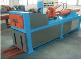
Figura 1: Removedor de cordón de alambres de acero
