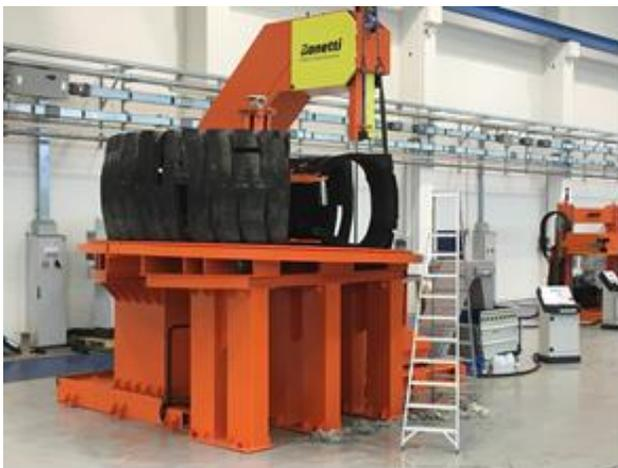
Imagen: Máquina de Corte Primario Modelo. 2000 NH-TYRE
