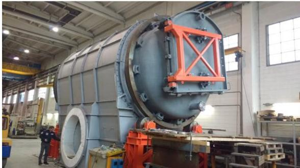
Imagen: Test en vacío de Reactores
