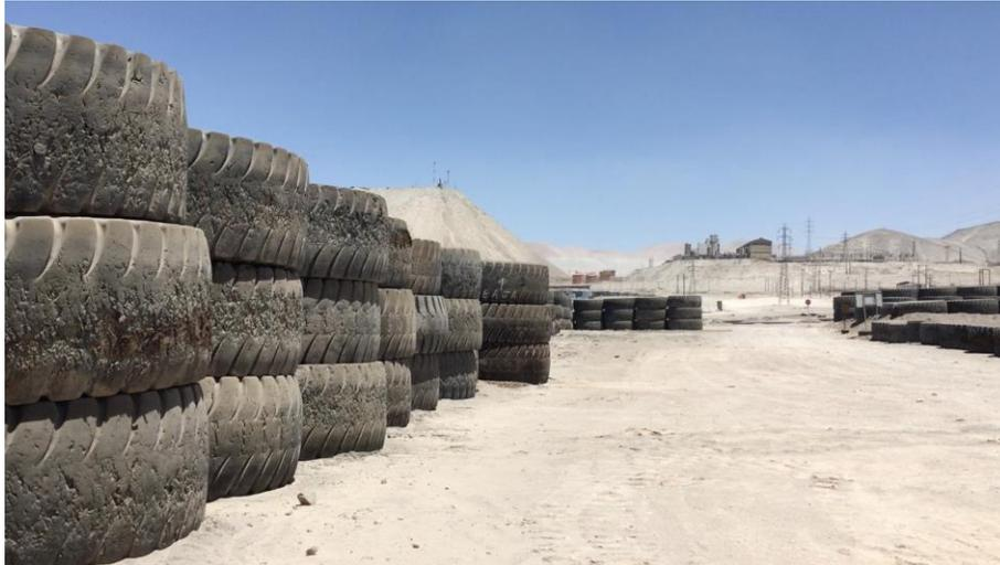
Figura 5: Apilamiento de 3 neumáticos por columna. Fuente: Patio de acopio de Chuquicamata.
